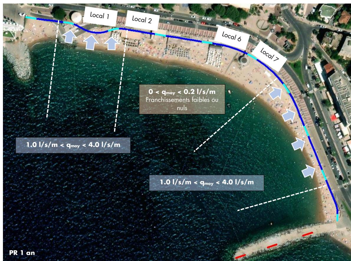
Figure 15 : Répartition schématique des franchissements et de leur intensité en conditions de PR 1 an
